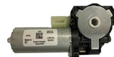
CM3G motoren zijn snel, geruisloos en hebben een hoge zelfremming en zijn terug te vinden in bijvoorbeeld sta-zitbureaus, verkoopautomaten en liftsystemen.
